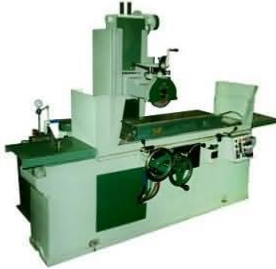
Resim 2.1: Yatay Milli Düzlem Yüzey Taşılama tezgâhi
