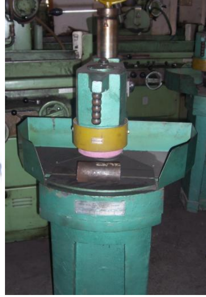
Resim 2.2: Düşey Milli Düzlem Yüzey Taşlama Tezgâhları
