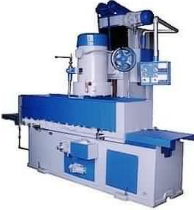
Resim 2.2: Düşey Milli Düzlem Yüzey Taşlama Tezgâhları
