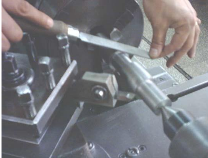
Resim 3.9: Eğe ve torna kalemi ile tornada kademelere pah kırma
