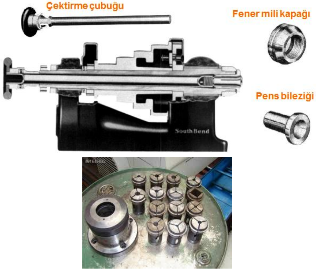
Resim 1.29: Pens mekanizması bağlantı şekli
