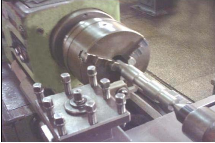
Resim 3.7: İş Parçasını ayna punta arasına bağlama
