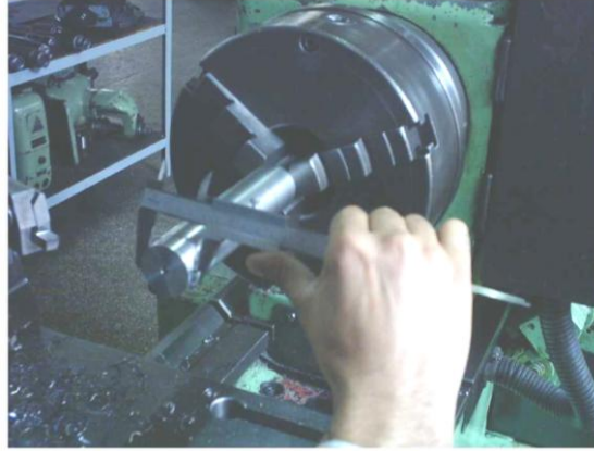
Resim 2.6: Torna tezgâhında kumpas ile dış çap ölçme
