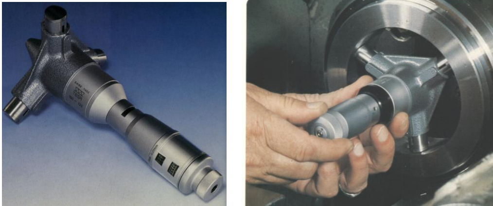
Resim 2.10: İç çap mikrometreleri ile ölçme yapma
