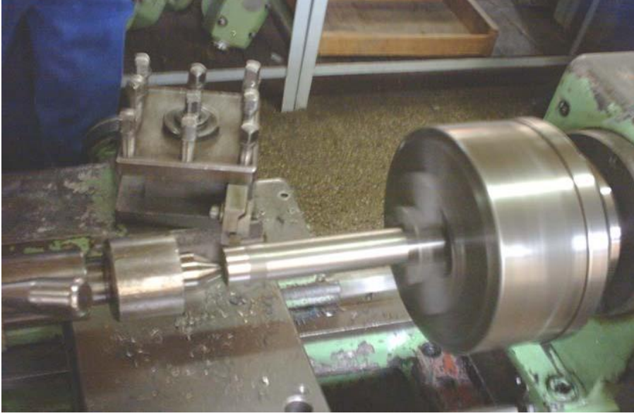
Resim 3.6: Silindirik dış yüzey tornalama
