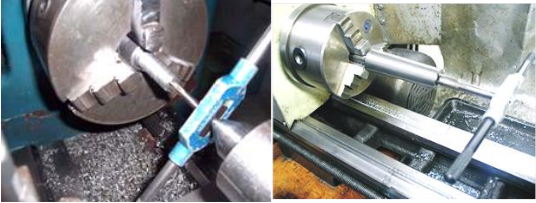
Resim 4.5 Kılavuzun Parçaya Ağzlatılması Ve Çekilmesi
