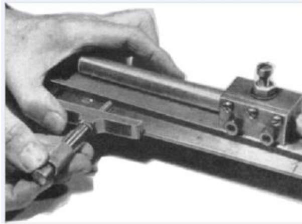
Resim 2.4: Sevk Kızağının Derinlik Mikrometresi Yardımıyla Ayarlanması
