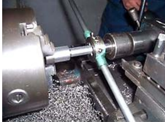
Resim 5.4 Paftanın Gezer Punta İle Desteklenmesi
