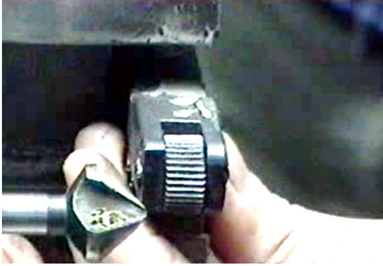
Resim 3.4: Tırtıl Makarasının Punta Ekseninde Ayarlanması
