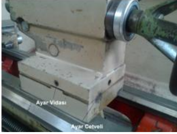
Resim 2.1: Gezer Puntayı Kaydırarak Konik Tornalama
