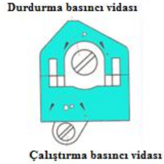
Şekil 3.11: Basınç şalterinin ayarlanması
