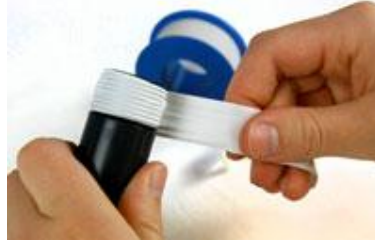
Resim 2.21: Teflon bant sıkma yönünün tersine sarılmalıdır
