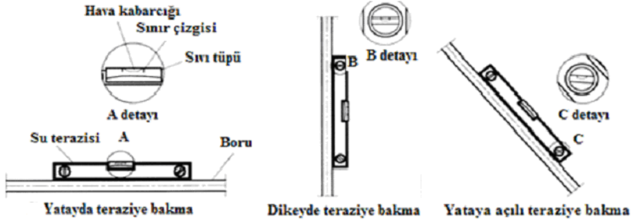
Şekil 2.9: Su terazisinin kullanılması
