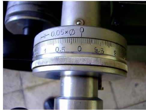
Resim 2.6: Kalemin parça üzerinde sıfırlanması
