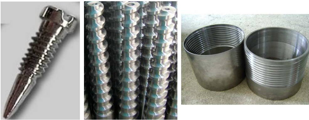
Şekil 2.4: Özel vida açılmış parçalar
