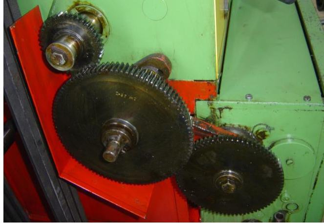
Resim 1.7: Diş atlatma metodunda kullanılan dişliler
