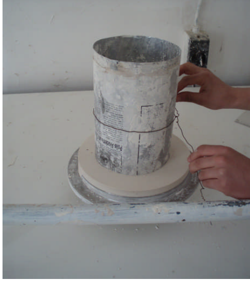
Resim 2.4: Esnek plakayı tel ile bağlama
