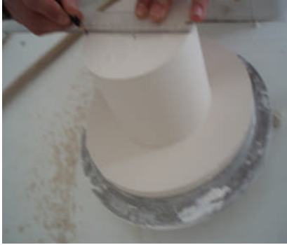
Resim: 2.7: Çap ölçüsünü işaretleme
