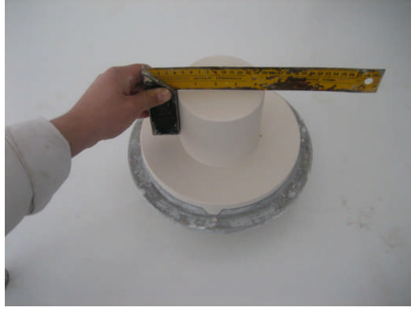
Resim 2.14: Silindirin üst yüzeyinin istenilen ölçüye getirilmesi
