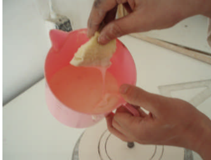
Resim 2.1: Arap sabunu ile yalıtma
