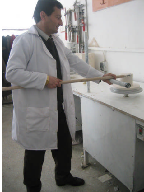
Resim 2.9: Torna bıçağının doğru tutuş şekli
