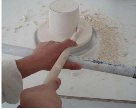
Resim 2.10: Silindirin gövdesini şekillendirme
