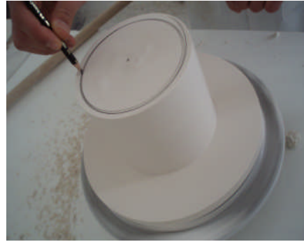
Resim: 2.7: Çap ölçüsünü işaretleme
