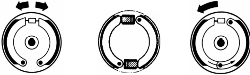
Şekil 1a: Tek etkili (simplex) Şekil 1b: Çift etkili (duplex) Şekil 1c: Servo etkili
