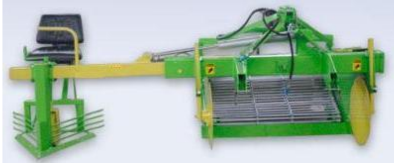
Resim 3.2: Soğan hasat makinesi
