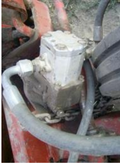
Resim 1.5: Bütün yağlı hidrostatik sistemlerin dönüşünü sağlayan kuyruk milinden tahrik alan hidrolik pompası
