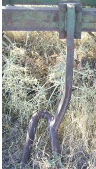
Resim 1.3: Sökücü ayağın şaseye bağlantısı ve çatalın monte edilmiş şekli
