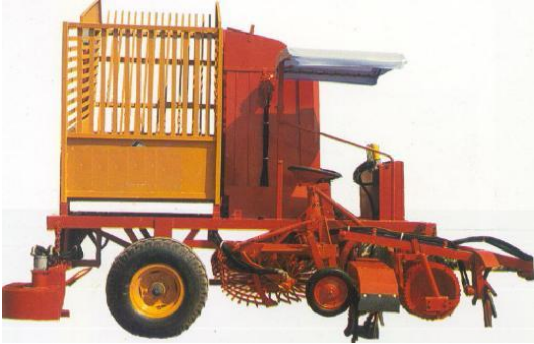
Resim 1.6: Hidrolik tahrikli depolu banth boşaltma sistemli yerli hasat makinesi
