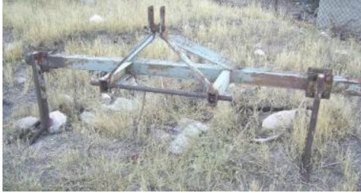
Resim 1.1: Tek sıra şeker pancarı söküm makinesi
