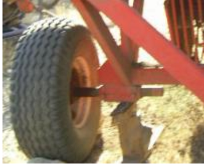
Resim 1.10: Şeker pancarı hasat makinesi tekeri
