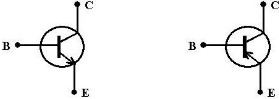
Resim 1.2: NPN ve PNP Transistörlerin sembolleri
