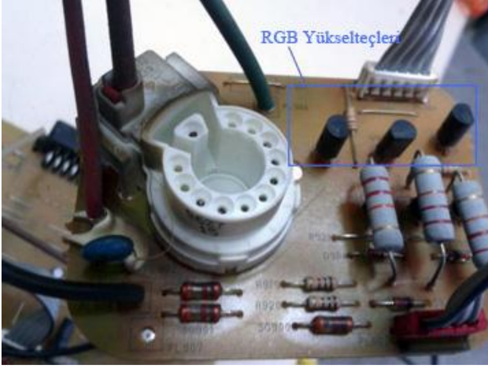
Resim 1.5: CRTkartı eleman yüzeyi
