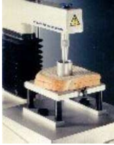
Resim 1.9: Penetrometre cihazında ekme ii sertlięinin ölçümü
