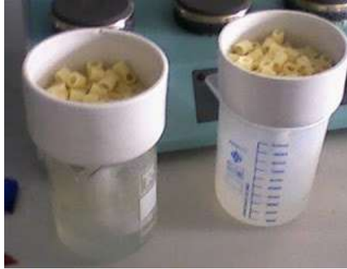
Resim 2.4: Makarna numunelerinin bühner hunisinde süzülmesi
