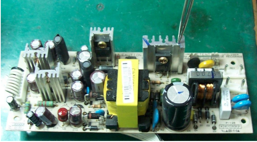
Resim 1.8: Voltaj yok IRF830'un kontrolü
