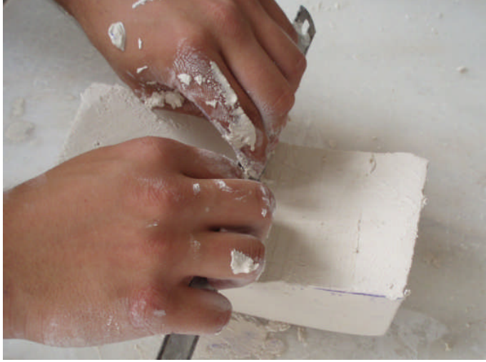
Resim 2.8: Demir testeresi ile fazlalıkları kazıma
