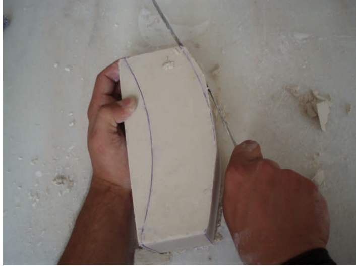
Resim 2.6: Çekirdeği keserek modeli kabaca ortaya çıkarma
