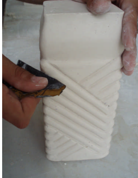
Resim 2.14: Vazo modelini zımparalama
