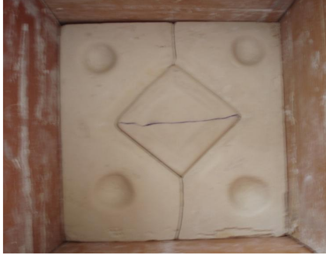
Resim 2.17: Üçüncü kalıp parçası için döküm alanının oluşturulması
