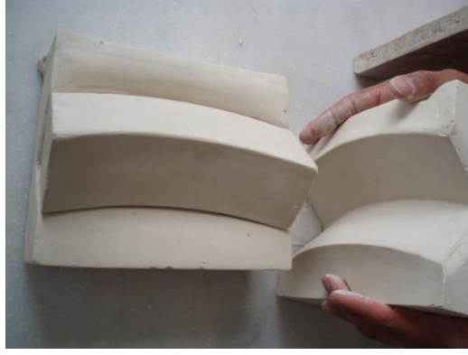
Resim 2.11: Kalıbın birinci parçasını ölü kalıptan ayırma
