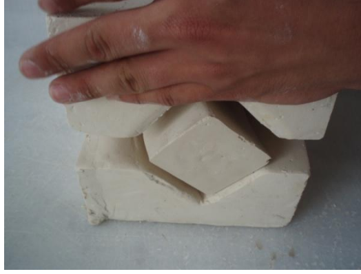
Resim 2.15: Kalıp parçalarının açılması
