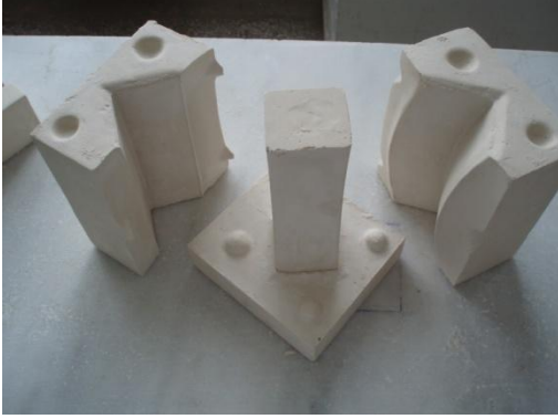
Resim 2.19: Modeli kalıptan çıkarma
