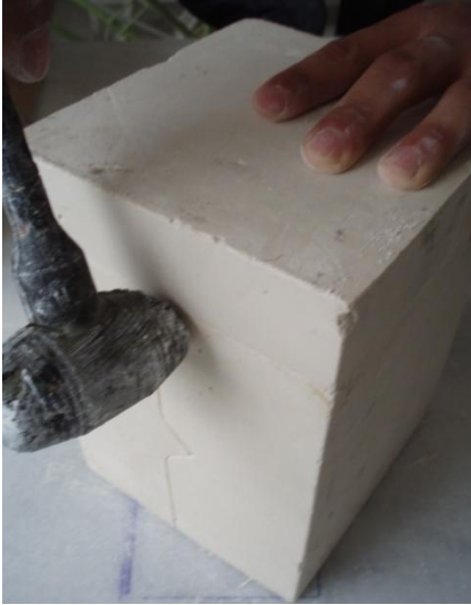
Resim 2.18: Üçüncü kalıp parçasını açma
