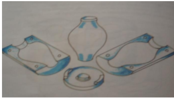
Resim 2.22: Modele uygun çok parçalı kalıp çizimi
