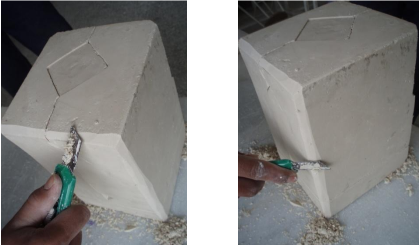
Resim 2.23: Kalıbın kenar ve köşelerini pahtlama
