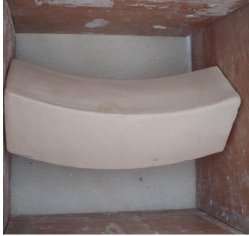
Resim 1.7: Ölü kalıp yapımı için döküm alanının hazırlanması
