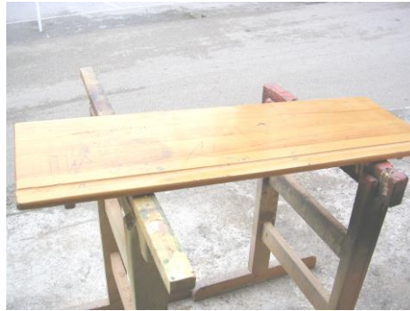
Resim 4.7: Yüzeyin dolgu verniğiyle kaplanması
