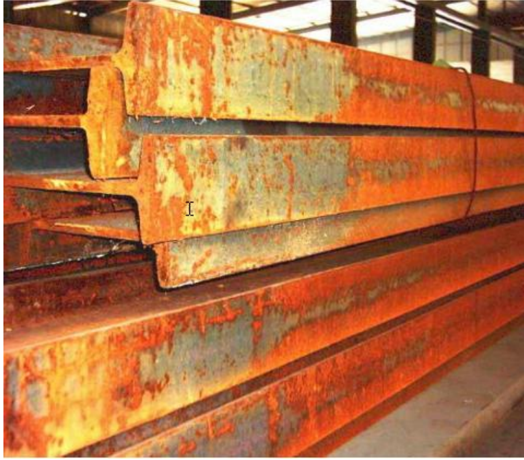
Resim 1.12: Herhangi bir kaplama yöntemi uygulanmamış ve uygunsuz koşullarda uzun süre depolanmış malzeme üzerinde oluşan pas tabakaları
