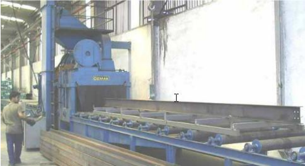
Resim 1.13: Kumlama makinesine malzeme girişi yapılırken
