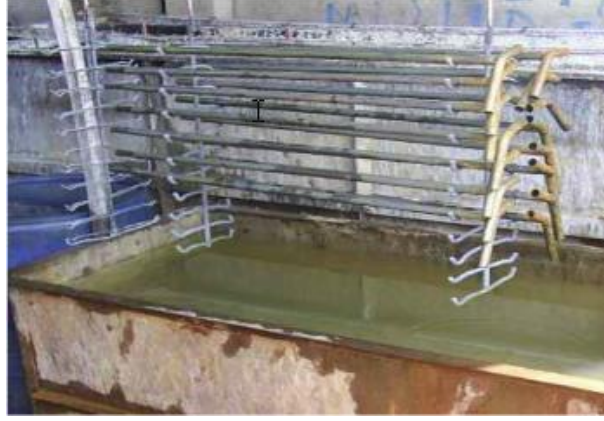
Resim 2.2: Asitle yüzey temizleme sonrası malzemeler durulanır
