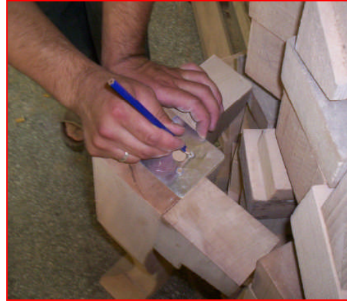
Resim 2. 16: İş parçası markalaması
