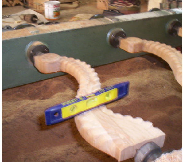
Resim 2. 14: Su terazisi ile bağlama
