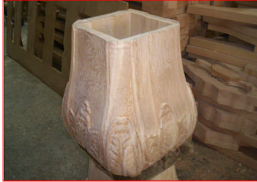
Resim 2. 25: Orta masası ayak göbeđi de kopyalama makinesinde işlenebilir
