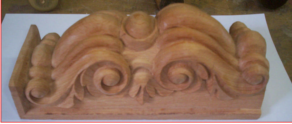
Resim 2. 1: Oyma makinesi için hazırlanmış kalıp paçası
