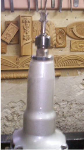
Resim 1. 24: El freze makinesi
