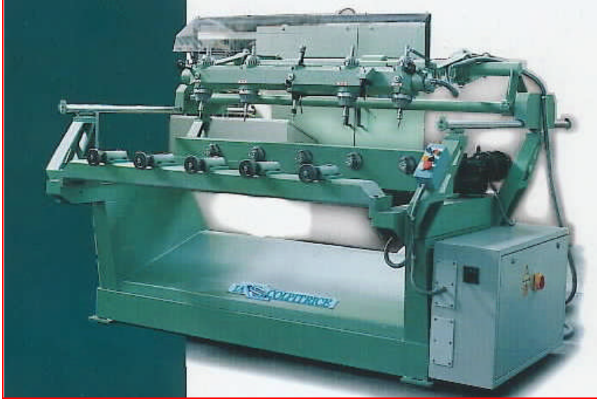
Resim 2. 5: Dört bıçaklı oyma makinesi
