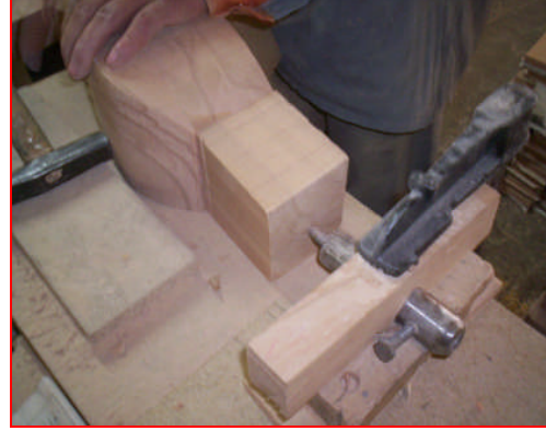
Resim 2. 17: İş parçası merkezlemesi
