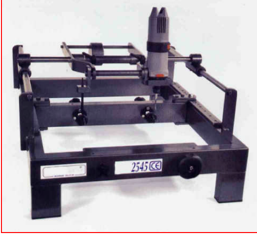
Resim 2. 3: Bir (tek) bıçaklı oyma makineleri
