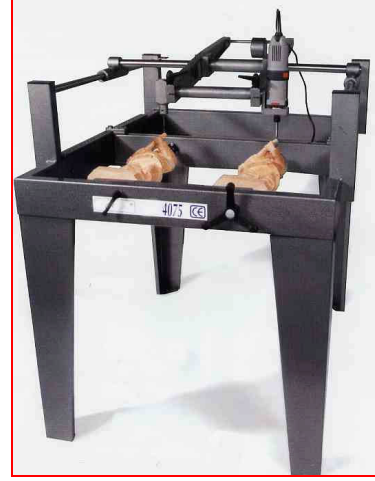
Resim 2. 3: Bir (tek) bıçaklı oyma makineleri
