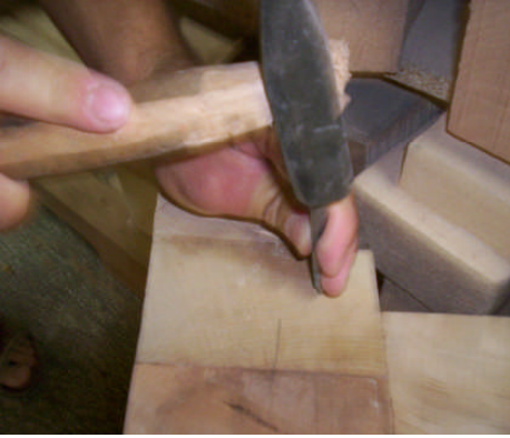
Resim 2. 17: İş parçası merkezlemesi
