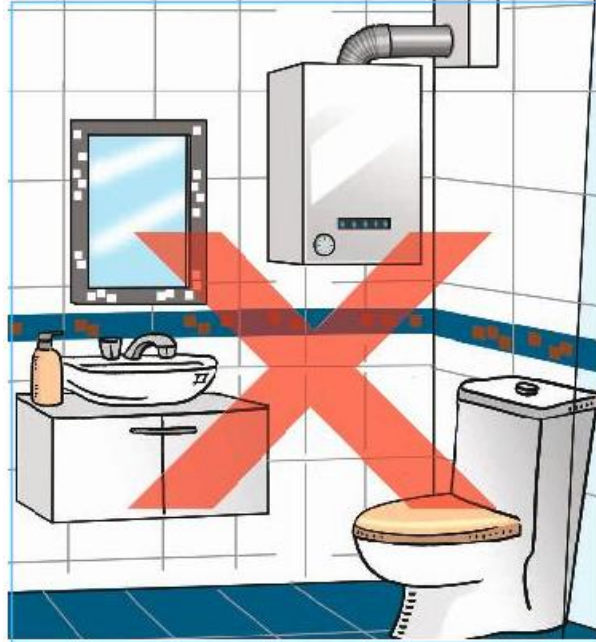
Şekil 3.2: Yanlış ortama şofben montajı
