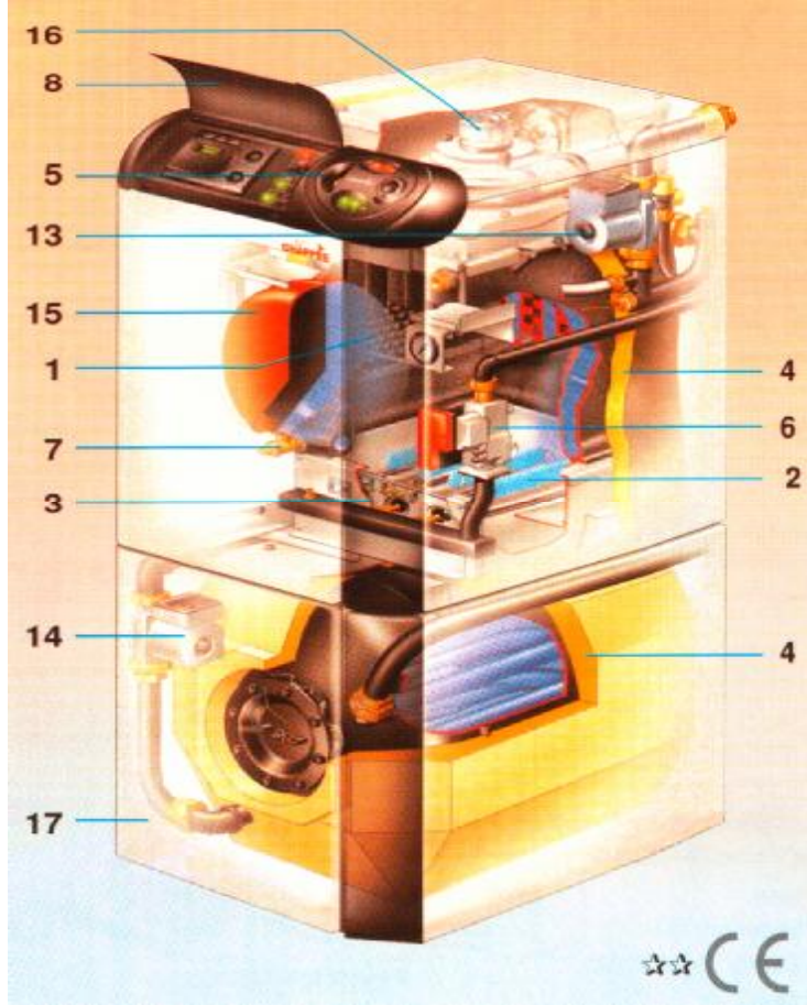
Resim 1.1: Bacalı elektronik ateşlemeli, boylerli kat kalorifer kazanı
