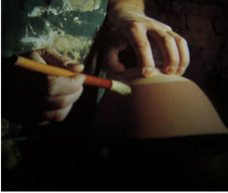
Resim 6.1: Fırça ile astarlama
