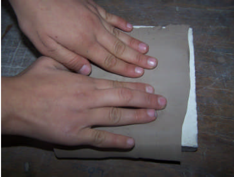
Resim 3.13:Kalıba çamur bastırma
