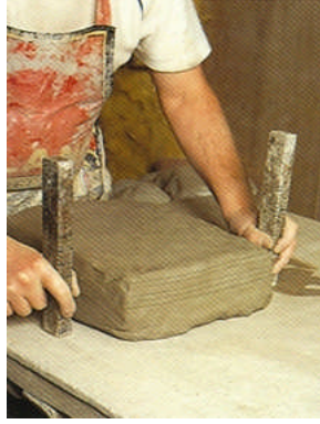
Resim 1.6: Merdane ile plaka Resim 1.7: Tel ile plaka kesme Resim 1.8: Kesilen plakaların ayrılması
