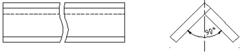
Şekil 2.1: İç köşe kaynağında birleştirme çeşitleri
