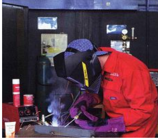
Resim 1.1: Kaynak hazırlığı yapılmış ve güvenlik önlemleri alınmış kaynak işlemi
