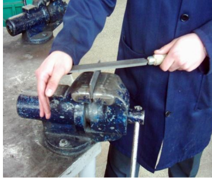
Resim 1.2: Eğe ile parça yüzeyi temizleme
