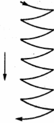
Çizim 2.4. Dolgu pasoları için önerilen elektrot hareketi
