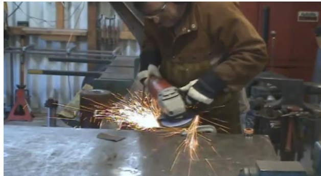
Fotoğraf 1.2: Seyyar zımpara ile kaynak ağzı açma
