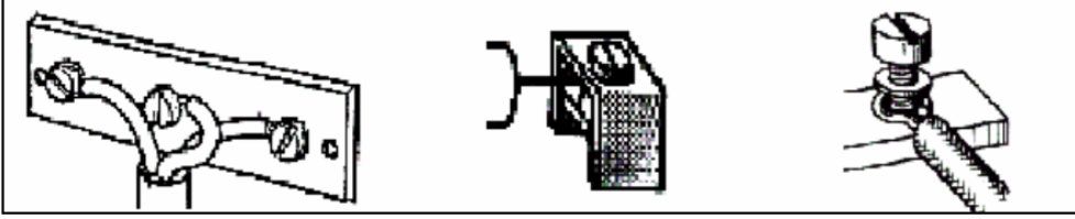
Resim 1.50: İletkenlerin terminallere bağlantısı
