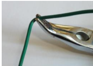
Fotoğraf 1.49: Kargaburnu ile iletkenin bükülmesi
