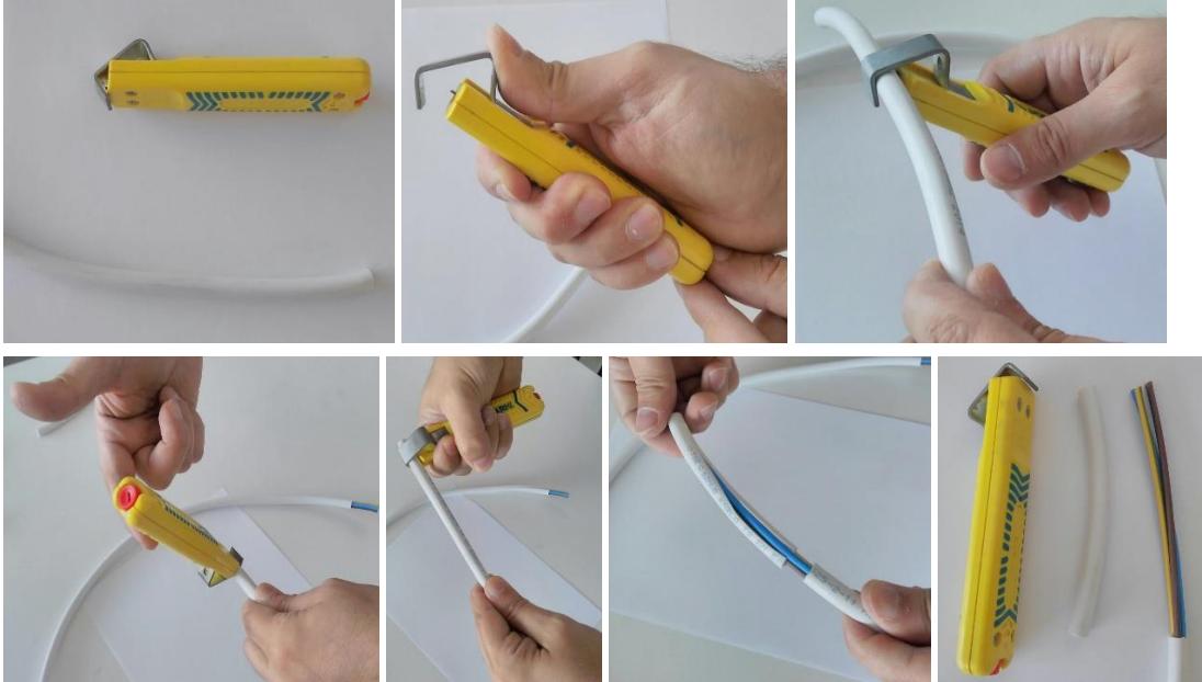
Fotoğraf 1.54: İletkenlerin joker kablo soyucu ile soyulması
