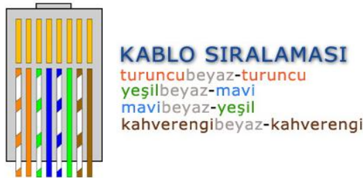
Resim 2.30: Cat5 Veri İletişim Data Kablosu bağlantısı
