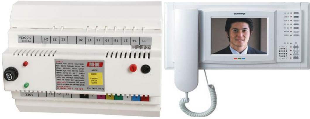
Resim 2.3: Bir diyafon santrali ve görüntülü telefonlu konuşma ünitesi
