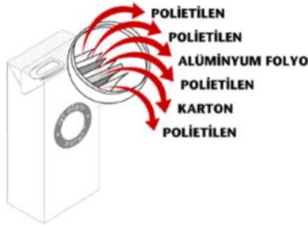
Şekil 1.1: Aseptik karton ambalajın yapısı
