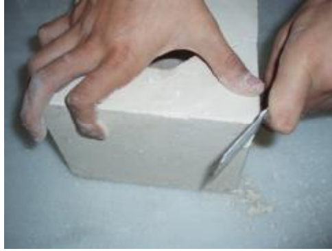
Resim 4.3: Kalıbın kenar ve köşelerini pahlama
