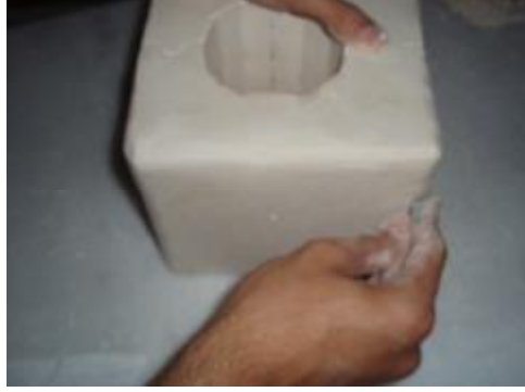
Resim 4.4: Kalıbın kenar ve köşelerini zımparalama
