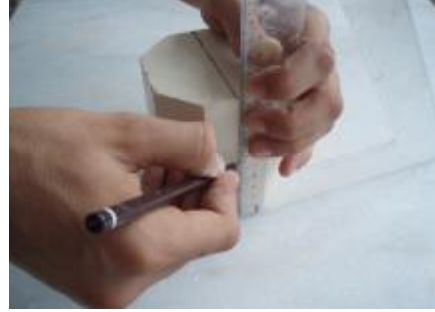
Resim 2.4:Gönye yardımı ile modeli iki eşit parçaya ayırma
