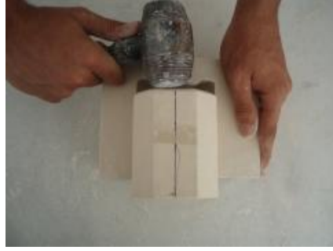
Resim 3.4: Modeli birinci kalıp parçasından çıkarma
