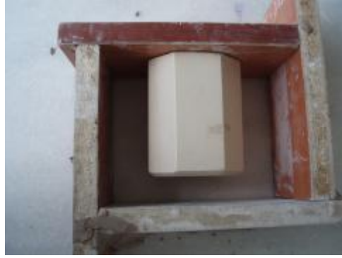
Resim 2.10: Kurgu tahtaları ile döküm alanını oluşturma
