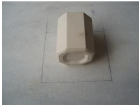
Resim 2.9 : Kalıp cidar kalınlığını masa üzerine markalama
