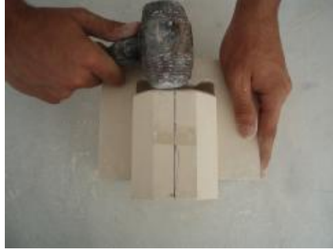
Resim 2.13: Ölü kalıp içinden modeli plastik tokmak yardımı ile çıkartma
