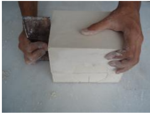
Resim 3.2: Kalıp parçalarını ayırmak için sistire ile kazıma
