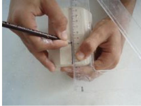
Resim 2.8: Modeli çizim ile ortadan ikiye ayırma
