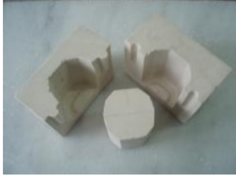
Resim 3.10: İki parçalı kalemlik kalıbı ve modeli
