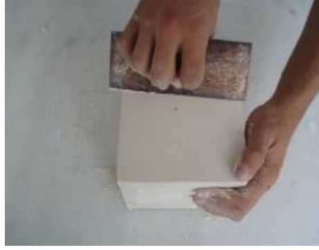
Resim 4.2: Kalıbın kenarlarını rötüşlama
