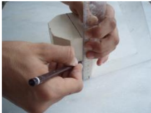
Resim 2.7: Gönye yardımı ile modeli iki eşit parçaya ayırma
