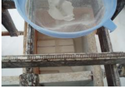
Resim 3.9: Kalıbın ikinci parçası için alçı döküm yapma
