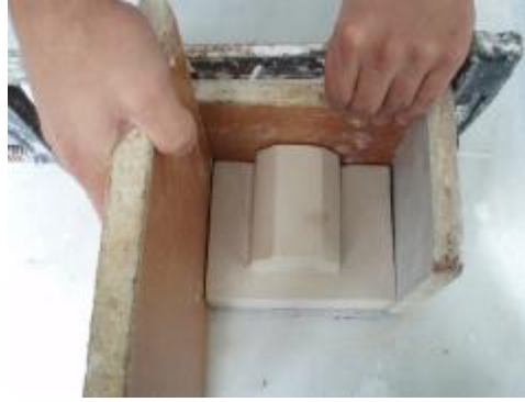
Resim 3.1: Döküm alanının oluşturulması
