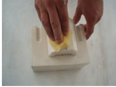
Resim 3.7:Modeli ve kalıp parçasını sabun ile yalıtma
