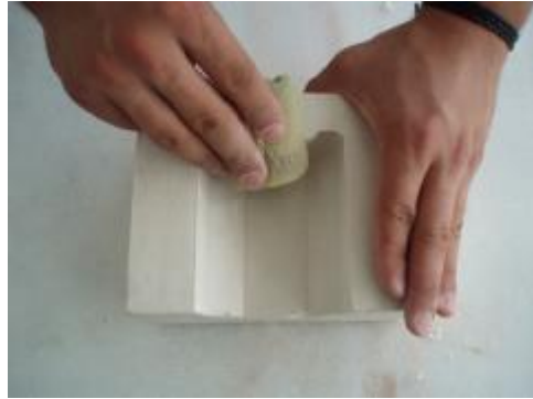
Resim 4.1: Kalıp iç yüzeyini rötuşlama
