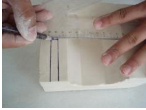
Resim 3.5: Pim yerlerinin belirlenmesi
