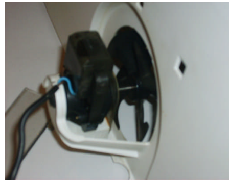
Resim 4.6: Evaporatör fan motoru
