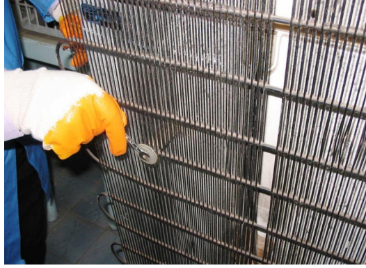
Resim 3.11: Kondenserin buzdolabından demontajı
