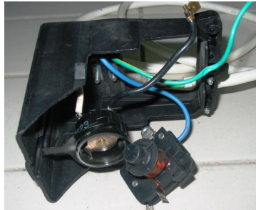
Resim 1.3: Röle, termik ve klemens kutusunun görünümü
