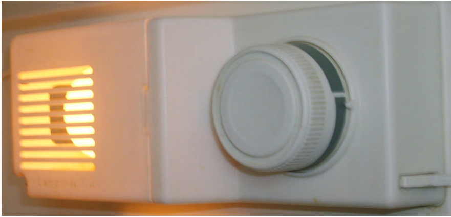
Resim 2.3: Duy-anahtar ve termostat grubu bir arada
