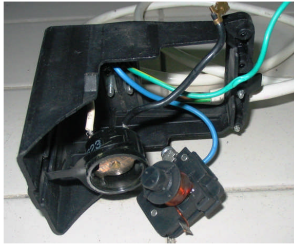
Resim 2.7: Röle, termik ve klemens kutusunun görünümü
