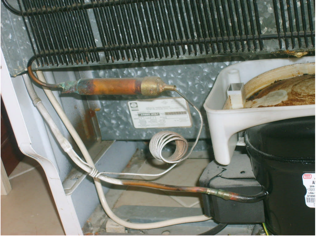
Resim 1.7: Kılcal borunun soęutma devresindeki yeri
