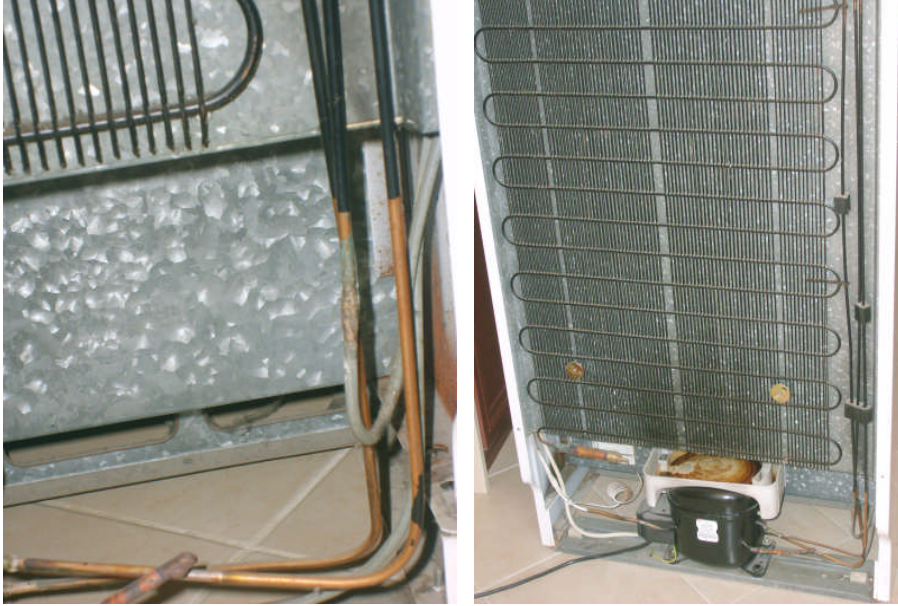
Resim 7.1: Kondenserin soğutucuya monte edilmesi
